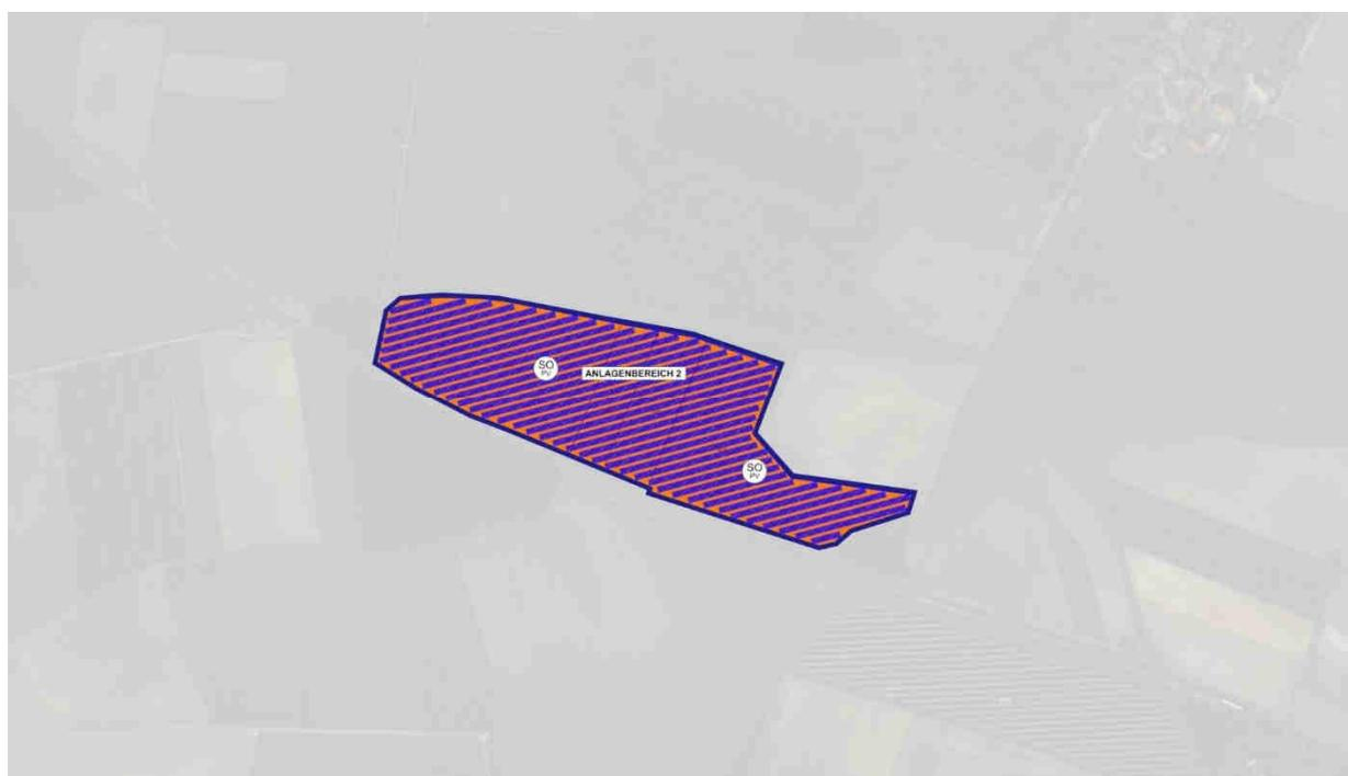
westlich liegender Anlagenbereich 2, Ausrichtung der Modulreihen nach 165° Südsüdost bei 15° ... 25° Aufneigung
