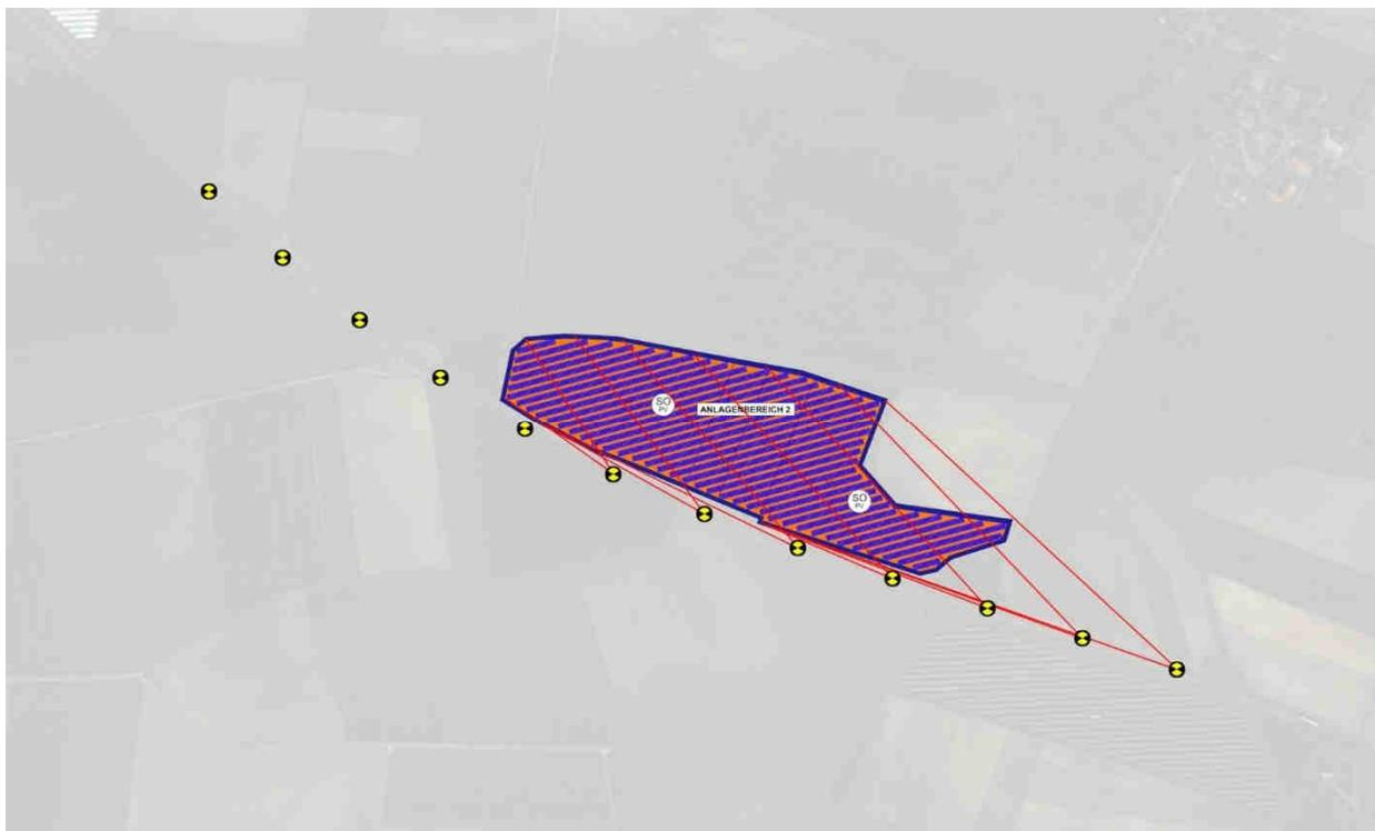
Bei der vorliegenden Geometrie wurden in Richtung der jeweils entfernten Beobachter in dieser Fahrtrichtung lediglich kurzzeitige Streiflichtreflexionen in den Tagen um die Sommersonnenwende herum an den südwestlichen Moduloberflächen dieses Anlagenteils ermittelt, die beim Näherkommen verschwinden.
