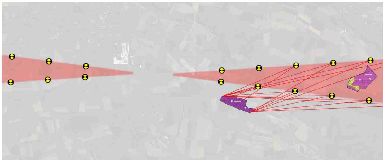
In dieser Situation können bei entsprechenden Sonnenständen und Witterungsbedingungen für Beobachter in größeren Entfernungen > ca. 950 m Blendreflexionen auftreten, die je nach Geschwindigkeit des Luftfahrzeugs als ein für ca. 15 s ... 25 s über die sichtbare Fläche der Anlage wandernder Lichteffect sichtbar sein können und die beim Näherkommen verschwinden.
