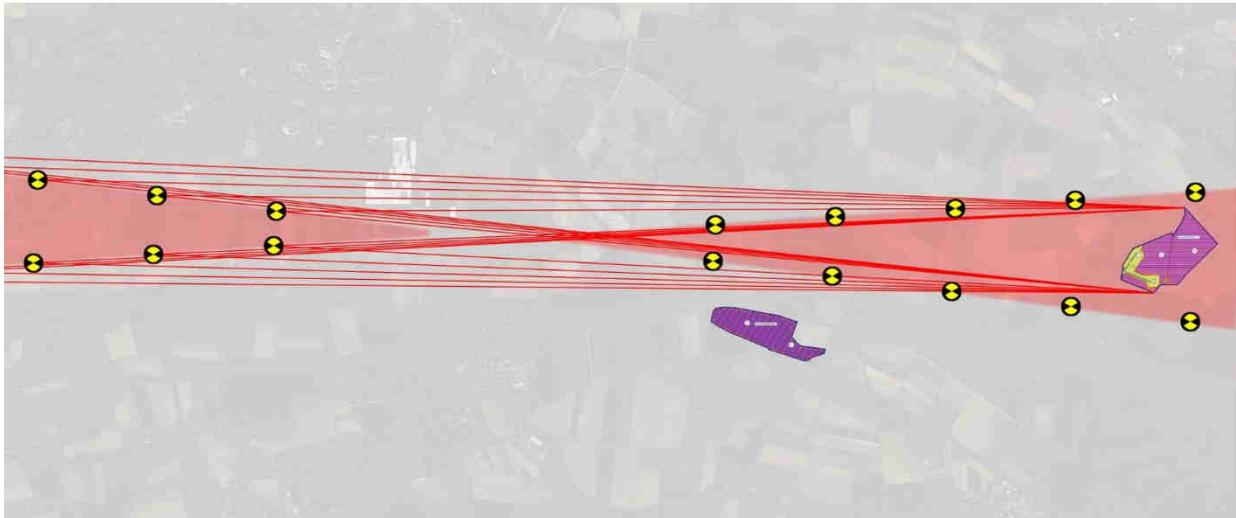
Dabei können an diesen Moduloberflächen Sonnenlichtreflexionen unter kleinen Blickwinkeldifferenzen  $< 10^\circ$  entstehen, die durch die Direktblendung der tiefstehenden Sonne überlagert und daher nach dem zu Grunde liegenden Bewertungsverfahren /1/ nicht als Blendung eingestuft werden.
